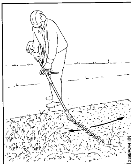
Horizontaal werken (met onder een hoek staande mesbalk)
